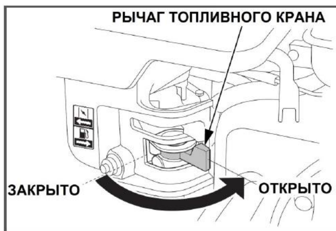
Рис. 7 Рычаг топливного крана
