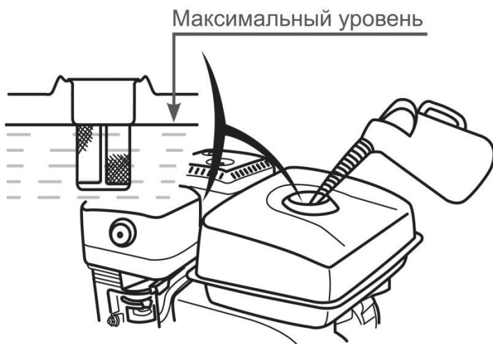
Рис. 4 Максимальный уровень топлива в топливном баке
