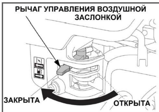
Рис. 6 Рычаг управления воздушной заслонкой
