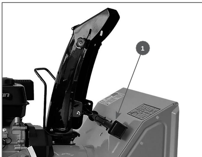
Рис. 11 Расположение лопатки для очистки
