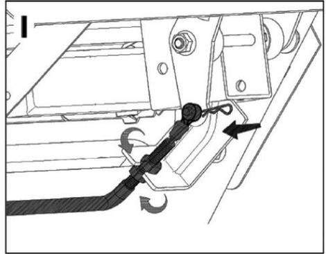
Рис. J. Закрепите трос управления дефлектором желоба поз.3 (Рис.1) в петле для фиксации, находящейся возле горловины для заливки масла.
