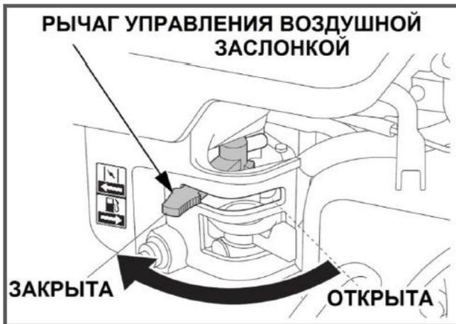
Рис. 8 Рычаг управления воздушной заслонкой
