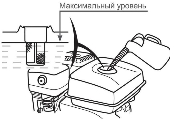
Рис.6 Максимальный уровень топлива в топливном баке
