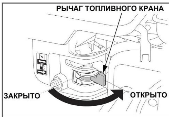
Рис. 9 Рычаг топливного крана
