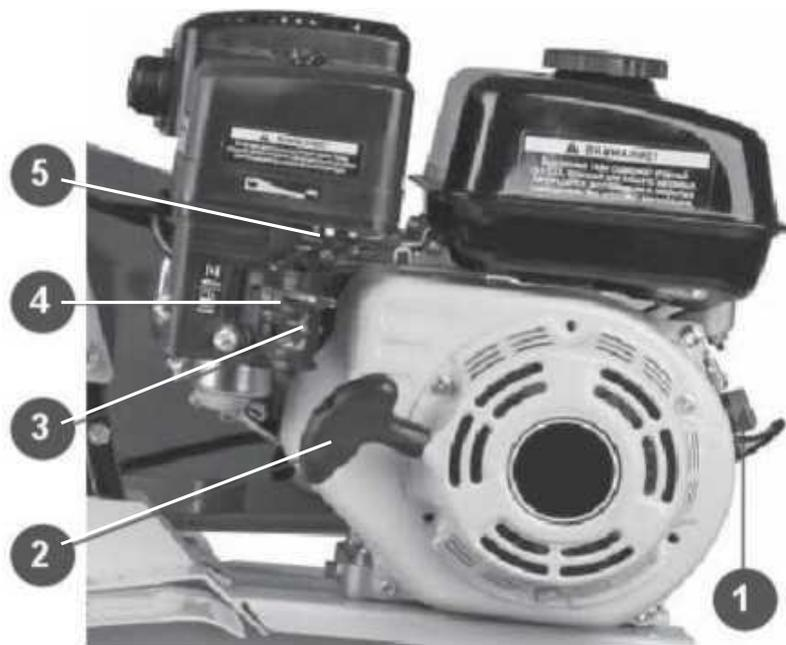
Рис.9. Основные органы управления двигателем.
