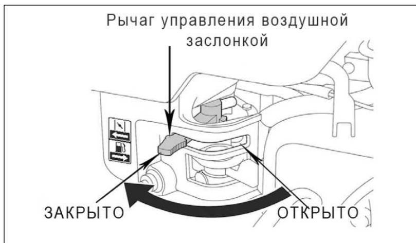
Рис. 10. Рычаг управления воздушной заслонкой
