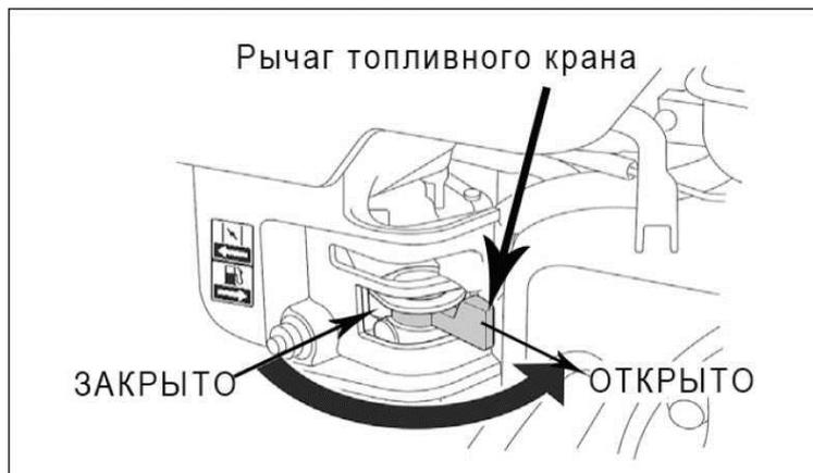
Рис. 11. Рычаг топливного крана
