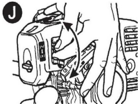
и оставьте его в полностью открытом положении. Не переводите рычаг воздушной заслонки в полностью открытое положение сразу же после запуска двигателя, если двигатель является холодным или, если он запускается при низкой температуре окружающего воздуха.
